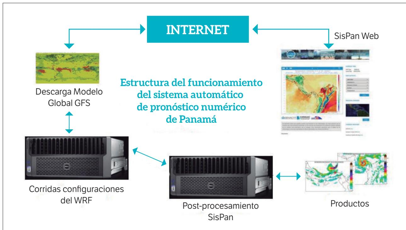
**Figura 3.** Estructura del funcionamiento del Sistema de Predicción Numérica del Tiempo de Panamá SISPAN.
